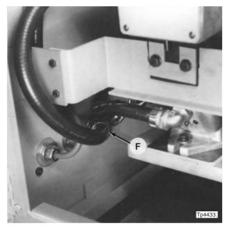
Figure 3.27 - Speed Change Conduit Nut
